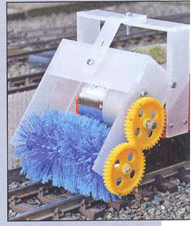
Offene Konstruktion: Rotierende Plastikborsten säubern die Gleise.
