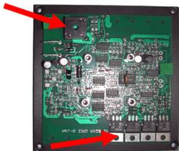
Bauform 1 diese funktioniert nicht mit dem MX7 Power Modul
