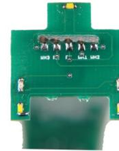
Die Platinen werden als „H-Brücke“ zusammengesteckt und von unten verlötet. Die beiden kleinen LED Platinen sind austauschbar es ist egal auf welcher Seite sie montiert werden.
