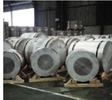
Übersee-Verpackung von Stahlcoils mit Stretchfolie R
