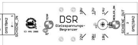
Regeln zur Verfügung. Die Schaltung leitet dennoch das Signal weiter, um etwa 2V reduziert, um einen Notbetrieb zu ermöglichen. Das Signal wird dann aber nicht mehr bearbeitet, eine Spannungsbegrenzung erfolgt dann nicht mehr.
