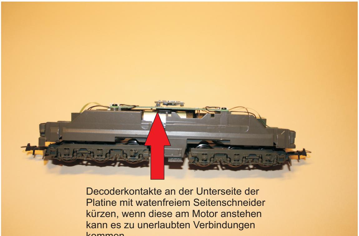
Decoderkontakte an der Unterseite der Platine mit watenfreiem Seitenschneider kürzen, wenn diese am Motor anstehen kann es zu unerlaubten Verbindungen kommen
