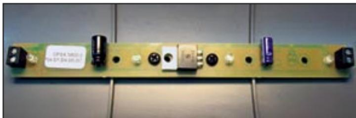
• Die digitale LED-Platine ist 30 cm lang und bietet neben den notwendigen Bauteilen für die Leuchtdioden noch einen Funktionsdekoder auf der Platine. Alle 18 LED können am Handregler über die Taste F1 komplett geschaltet werden, oder mit den Funktionen F2 bis F7 in sechs Gruppen.
